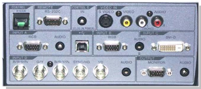
face (DVI-D) Schnittstelle. Der Input D besitzt 5 BNC-Buchsen, über die RGB- und Komponentensignale angeschlossen werden können.
